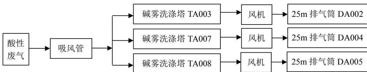
图 4.1-5 酸性废气处理工艺流程图
